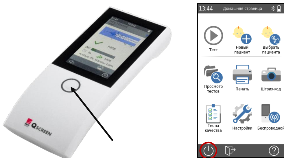
3-сурет: Қосу/өшіру ауыстырып қосқышы (сол жақта: қосу/өшіру ауыстырып қосқышы (құрылғыны қосу/өшіру үшін), оң жақта: экрандағы қуат түймесі)
