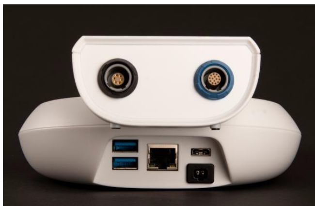
4-сурет: QSCREEN құрылғысындағы ағытпалар (жоғарыда), базалық станциядағы ағытпалар (төменде)
